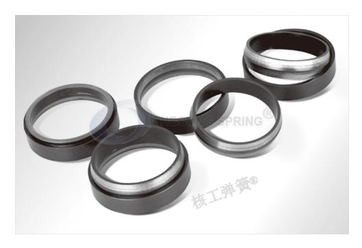
上海核工分析环形弹簧表面处理: (1) 煮黑处理: 这种表面处理提供黑色表面,煮黑是为了外观美化重于抗腐蚀。(2) 镀铬: 镀铬主要是对碳钢产品的处理方法,目的主要是为了增加抗腐蚀性。(3) 油浸: 油浸是对碳钢浐灞的标准处理方法,目的是为了防止运输和存储过程中的锈蚀。(4) 钝化: 钝化是不锈钢材料的一种清洁方法。(5) 磷酸盐涂层: 磷化抗腐蚀能力优于煮黑。(6) 超声波清洗: 这是不锈钢材质的标准和表面处理法。(7) 振动去毛刺: 为了消除产品尖锐部分。更多信息可以关注我司官网。
